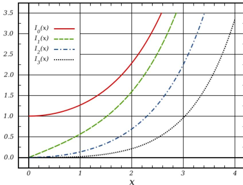
Figura 7. Funciones de Bessel modificadas de primer tipo,  $I_n(x)$ , para  $n = 0, 1, 2, 3$ .
