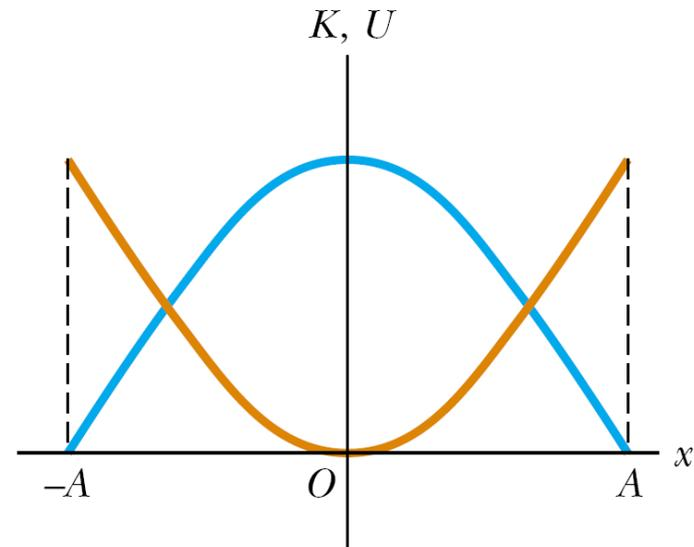
Graficas de las energías potencial y cinética para un oscilador armónico como funciones del tiempo y de la posición.
