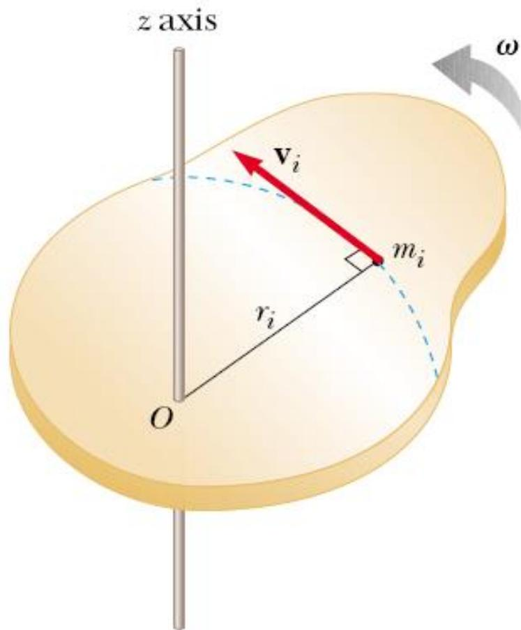
Para el cálculo de la energía cinética rotacional de un cuerpo rígido una buena idea es considerarlo como una colección de partículas rotando alrededor del eje fijo  $z$ , con una rapidez angular  $\omega$ .
